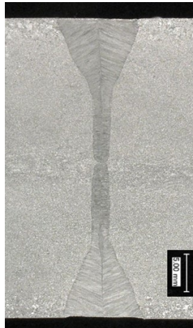
Fig. 4. Crosssection; 1.4301; P_L= 16 kW, v_s= 1,2 m/min, A= 1,5 mm
